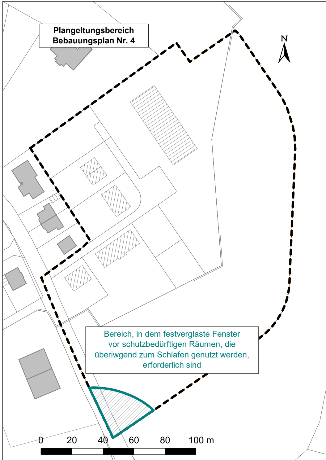
Abbildung 3: Darstellung des Bereiches, in denen festverglaste Fenster vor schutzbedürftigen Räumen, die überwiegend zum Schlafen genutzt werden, erforderlich sind
